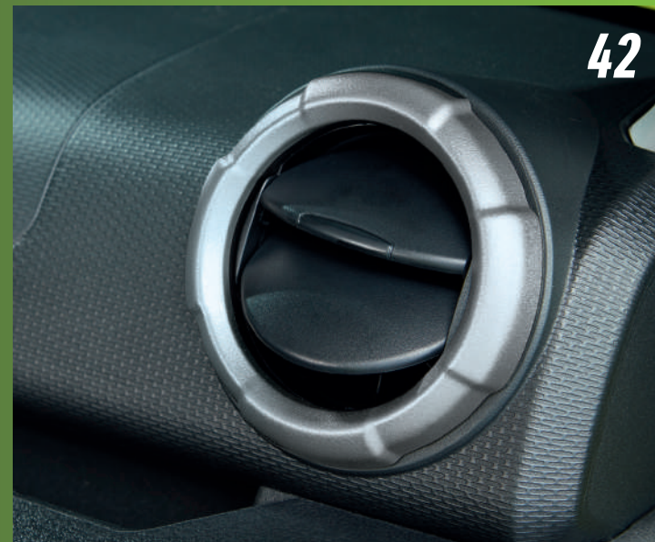
42 - Ventilador de aire acondicionado
